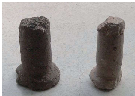
重ねた器が油薬で接着しないよう窯詰め用いるトチン
